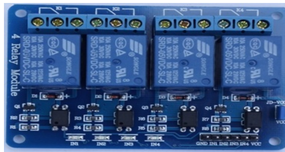
Hình 5: Mạch Relay thực tế
